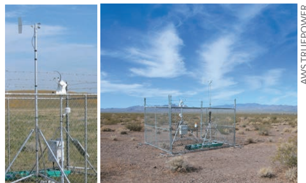
FIGURA 5.2 » Configuração típica de estação solarimétrica padrão EPE.
